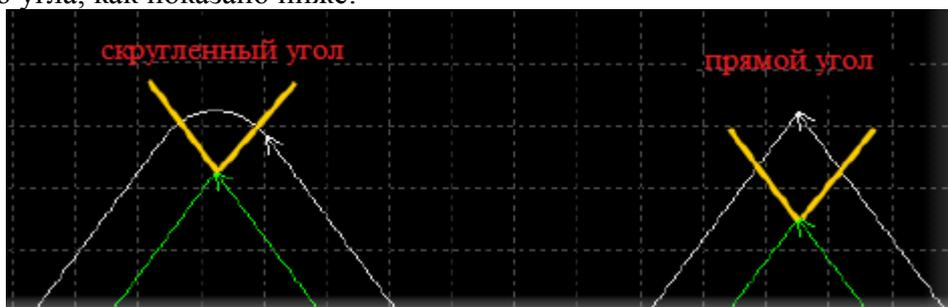
На рисунке зеленым цветом изображен исходный вариант, белым - скорректированная траектория, светло-желтым – вертикальные линии, выходящие из угла. На рисунке видно, что кромка реза совпадает с исходной после коррекции обеих сторон вертикальных линий, в то время, как необходимо преобразование угла. Обычно закругленный угол используется при совпадении кромок реза с исходными, и обеспечивает более плавное перемещение.
